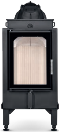
HE 37/50G größerer Feuerraum, Gusskuppel Ø180 mm mit Putzdeckel
