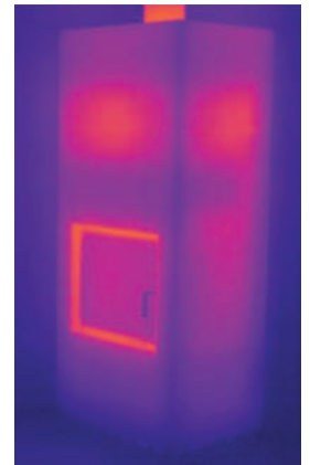
8 Std. nach dem Anheizen Durchschnittliche Oberflächentemperatur 46 °C
