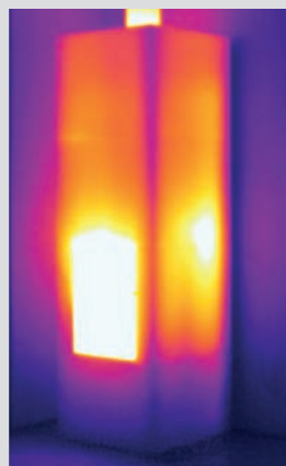
3 Std. nach dem Anheizen Durchschnittliche Oberflächentemperatur 88 °C
