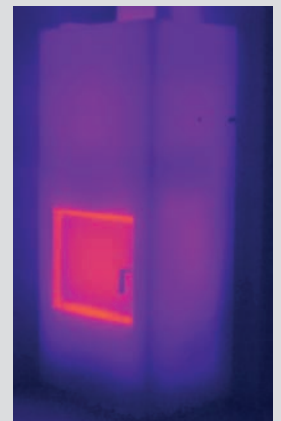
3 Std. nach dem Anheizen Durchschnittliche Oberflächentemperatur 37 °C
